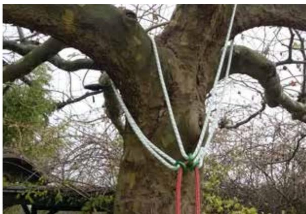
multiANCHOR in Verwendung als doppelter Anker
