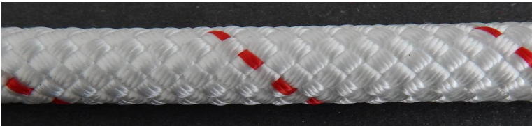
Abb.1: Patron 11mm – nach Behandlung mit Benzin für 15 min
