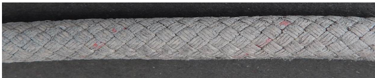
Abb.3: Patron 11mm – mit Korrosionsschutzfarbe bestrichen
