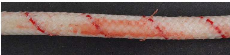
Abb.2: Patron 11mm – nach Behandlung mit Batteriesäure für 5 min.
