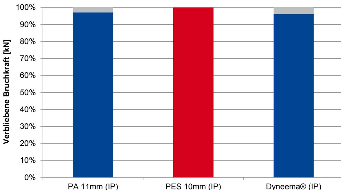
Die Ergebnisse zeigen, dass bei Polyester Seilen zu keiner Abnahme kam und die Abnahme bei den anderen Seilen nur 2-4% betrug. Jedoch bemerkten wir, dass sich Flexibilität und Handling des Seils durch die Desinfektion verschlechterten.
