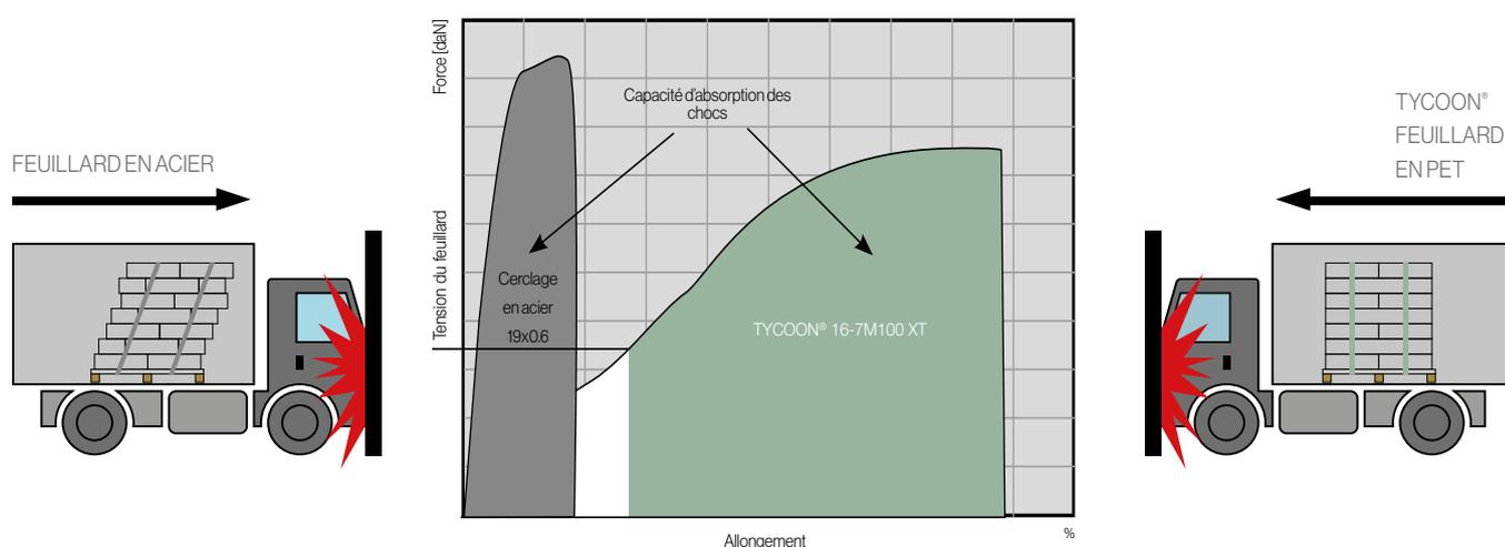
La capacité à absorber les chocs est une combinaison entre allongement et résistance à la rupture.
