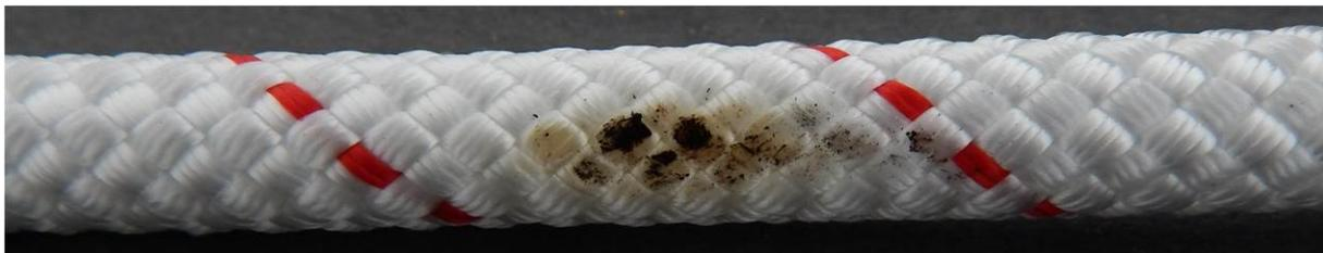
Abb.2: Patron 11mm bei 210°C für 5 min
