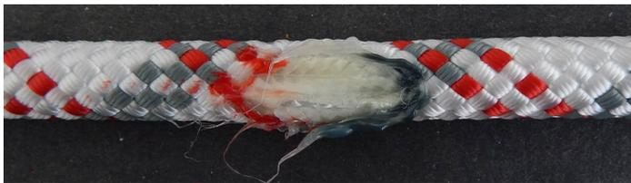
**Abb.5: Patron Plus 11mm bei 250°C für 1 min**
