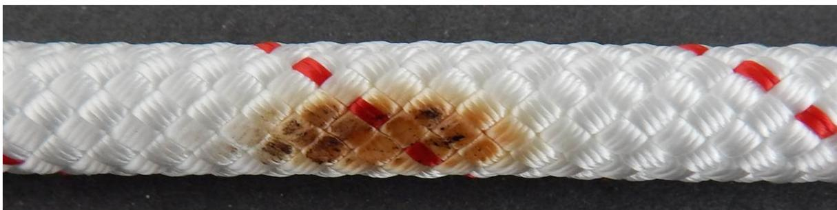
Abb.3: Patron 11mm bei 210°C für 20 min
