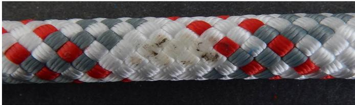
**Abb.4: Patron Plus 11mm bei 230°C für 1 min.**
