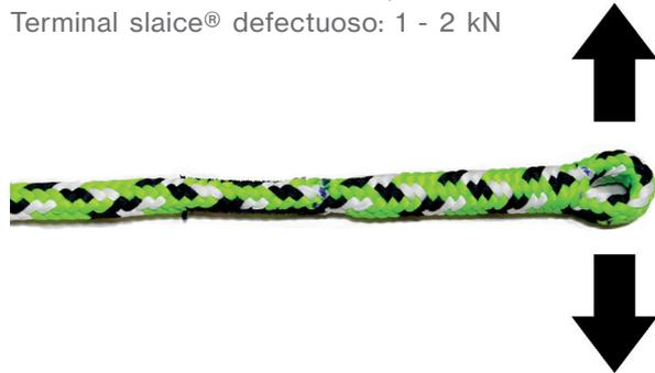
cuerda. La prueba en el modelo Braided Safety Blue® con el terminal slaice® defectuoso da el siguiente resultado:
