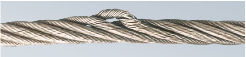
Abb. 87 - Austritt/Verformung einer Litze
