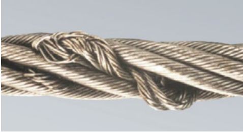
Abb. 85 - Austritt der Einlage
