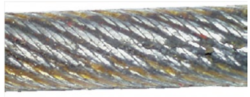
Abb. 65 - Erhöhter Seilverschleiß durch zu knappes Wickeln
