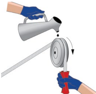
Abb. 71 - Manuelle Schmierung an der Seilrolle (symbolische Darstellung)
