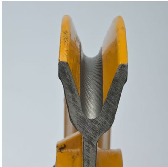
Abb. 36 - Furchen in einer gebrauchten Rolle
