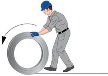
Abb. 39 - Ordnungsgemäßes Abwickeln eines Coils
