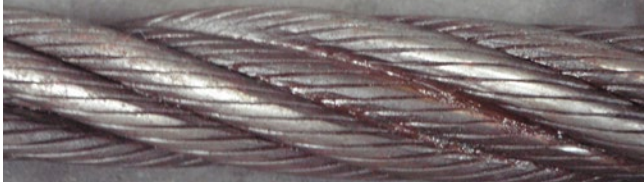
Abb. 76 - Lokale Abnahme des Seildurchmessers (ingesunkene Litze) Durchmessers kann durch äußeren Verschleiß verursacht werden
