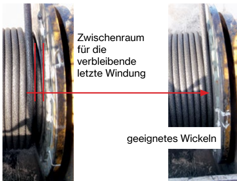
Abb. 53 - Geeignetes Wickeln der ersten Lage, um Zwischenräume zu Zwischenplatten und eine Quetschung des Seils zu vermeiden
