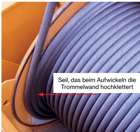
Abb. 55 - Seil, das aufgrund kleiner Ablenkwinkel beim Aufwickeln die Trommelwand hochklettert
