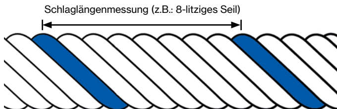
Abb. 31 - Messung der Schlaglänge, direkte Methode
