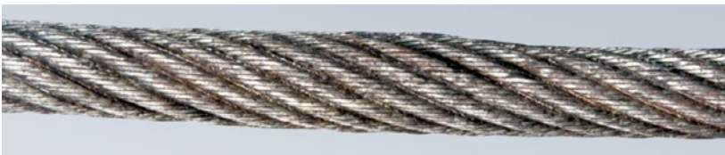
Abb. 89 - Lokale Zunahme des Seildurchmessers infolge einer Verformung der Einlage
