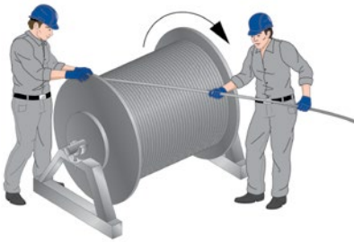
Abb. 41 - Ordnungsgemäßes Abwickeln von einer Haspel
