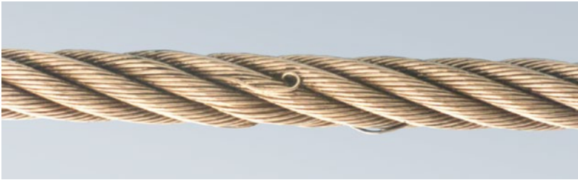
Abb. 88 - In Schlaufen hervorstehende Drähte
