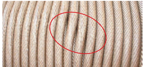
Abb. 67 - Lockeres Wickeln des Seils in den äußeren Lagen
