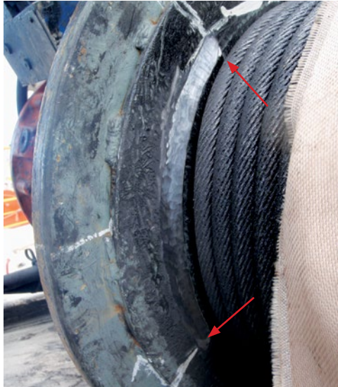
Abb. 54 - Verengung, welche Ablenkungen des Seils verursachen kann
