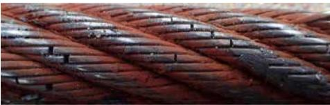
Abb. 80 - Reibkorrosion („Fretting Corrosion“) infolge von Kontakt zwischen Litzen
