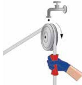
Abb. 70 - Automatisierte Schmierung an der Seilrolle (symbolische Darstellung)
