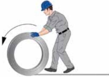
Abb. 39 - Ordnungsgemäßes Abwickeln eines Coils
