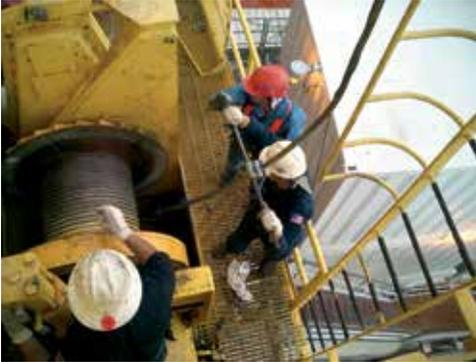
Abb. 58 - Befestigen Sie das Seil am Verankerungspunkt der Trommel
