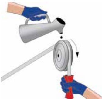
Abb. 71 - Manuelle Schmierung an der Seilrolle (symbolische Darstellung)
