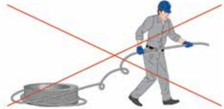
Abb. 40 - Unsachgemäßes Abwickeln eines Coils
