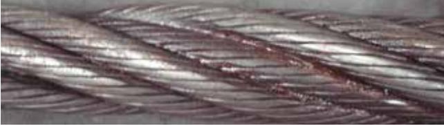
Abb. 76 - Lokale Abnahme des Seildurchmessers (ingesunkene Litze)
