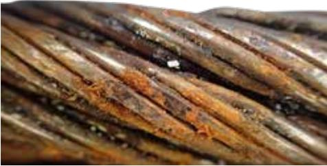
Abb. 79 - Äußere Korrosion
