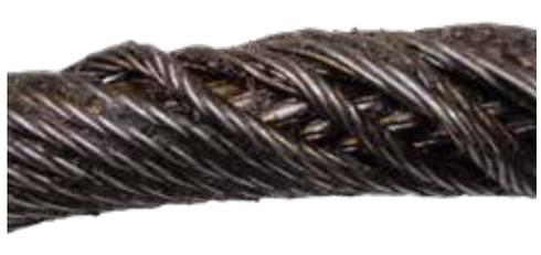
Abb. 92 - Mechanische Beschädigung
