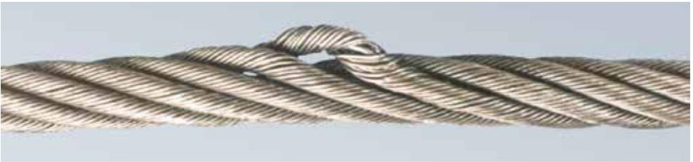
Abb. 87 - Austritt/Verformung einer Litze
