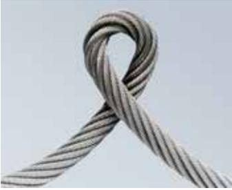
Abb. 95 - Klanke (zugezogene Seilschlinge)
