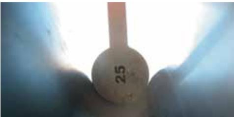
Abb. 34 - Rillen-Istdurchmesser 25,0 mm
