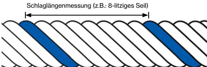
Abb. 31 - Messung der Schlaglänge, direkte Methode
