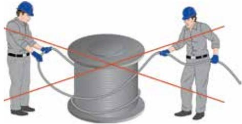
Abb. 42 - Unsachgemäßes Abwickeln von einer Haspel
