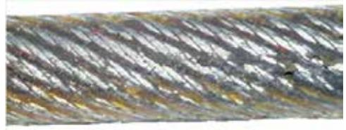
Abb. 65 - Erhöhter Seilverschleiß durch zu knappes Wickeln
