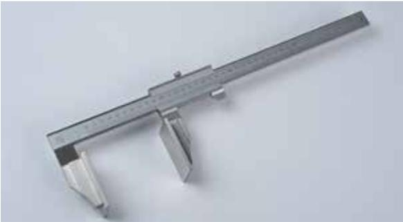
Abb. 30 - Schiebelehre mit breiten Backen
