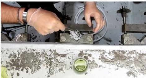
6) Der Drahtbogen zum Einarbeiten des Harzes muss einen  $\varnothing \leq 3\text{mm}$  aufweisen. Es ist darauf zu achten, dass die Fasern nicht Richtung Vergussgrund geschoben werden.
