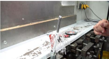
**Schneiden** Sie das Seil mit dem Messer/der Schere gerade und schieben Sie die Vergusshülse soweit über das Seil, bis dieses ca. 5 mm über die Vergusshülse hinausragt.
