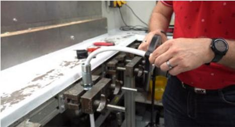
**Umwickeln** Sie das Seil im Bereich des unteren Endes der Vergusshülse mit einem Klebeband, sodass die nun markierte Seillänge ca. 1 cm länger als die Länge der Vergusshülse ist. Sie verhindern somit ein Ausfransen des Mantels und markieren gleichzeitig das Ende des Vergussbereiches.
