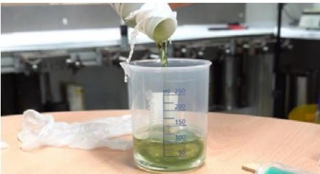
**Mischen** Sie die vordosierten Komponenten Harz + Härter im Mischgefäß zusammen. Verrühren Sie das Ganze für ca. 2 Minuten.
