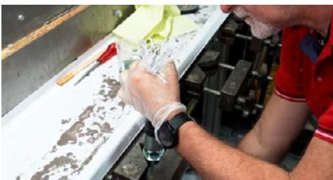
2) Den Vergussbesen so weit in die Verguss-hülse einziehen, bis das Klebeband unten an der Bohrung erscheint. Um ein Auslaufen des Harzes auf das Seil zu reduzieren, empfiehlt Teufelberger, den Übergang zwischen Verguss und Seilmantel in dieser Position nochmals mit einem zusätzlichen Klebeband abzudichten.
