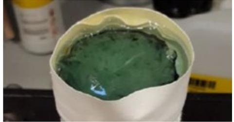
7) Das Harz muss schlussendlich aushärten. Dabei empfiehlt sich eine Trocknungszeit von mind. 12 Stunden, idealerweise bei einer Umgebungstemperatur  $>15^{\circ}\text{C}$ . Nachdem das Harz vollständig ausgetrocknet ist, werden die überstehenden Seilstränge mit einer Metallsäge abgeschnitten und das Gewinde der Vergusshülse mit Schleifpapier oder Drahbürste von Harz Resten befreit.
